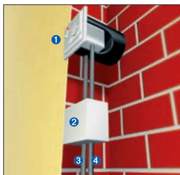
Regelgerät montiert in Schalterdose, Abzweigkasten für Temperaturbegrenzer und/oder beim Anschluss mehrerer Heizmatten
